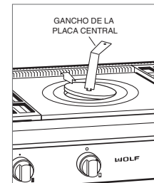
Retirada de la placa central
