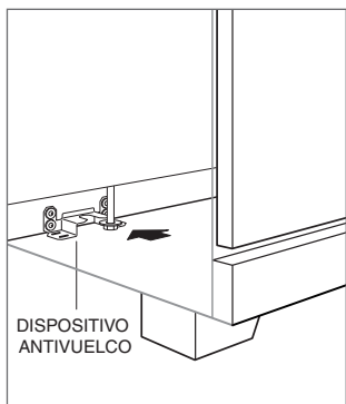
Ubicación del dispositivo antivuelco.
