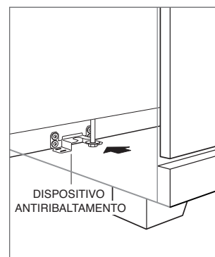
Posizione del dispositivo antiribaltamento
