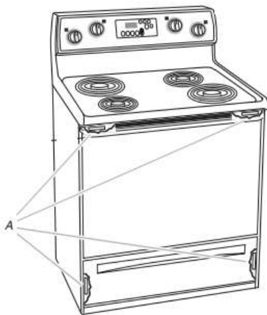
A. La plaque signalétique est située sur le châssis derrière un coin supérieur de la porte ou un côté du tiroir.
