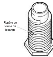
Pied de nivellement avec repère en forme de diamant
